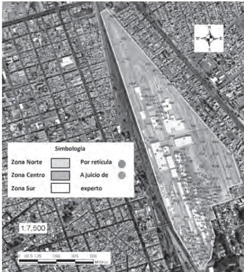
Figura 11. Zonas delimitadas para el muestreo del sitio y ubicación de puntos de muestreo. Los puntos rojos fueron asignados a juicio del experto en función del levantamiento técnico y los azules se ubicaron siguiendo una retícula predeterminada (Fuente: INSECAMI).
