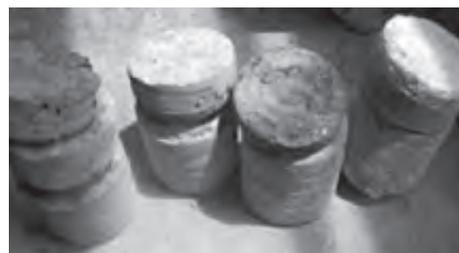
▲ **Figura 14.** Núcleos de concreto extraídos del fondo de las celdas de confinamiento en el año 2006 (Fuente: SEMARNAT).
