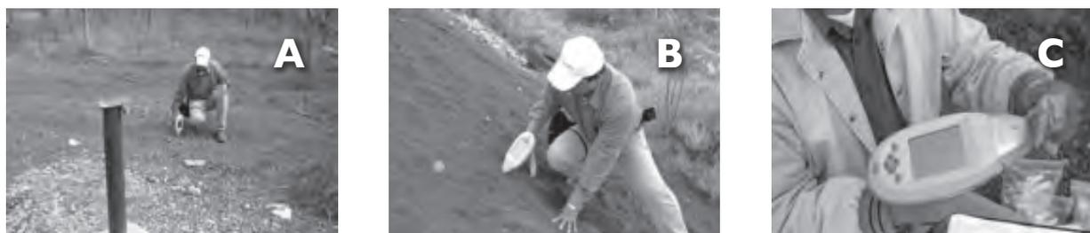
**Figura 11.** Lecturas con un instrumento de FRX, marca Niton Modelo XLt 800 series, A) Lecturas en la superficie del terreno, B) Toma de lecturas en escoria granular, C) Lecturas en muestras de recortes de perforación. (Fotografías: UANL, 2005).
