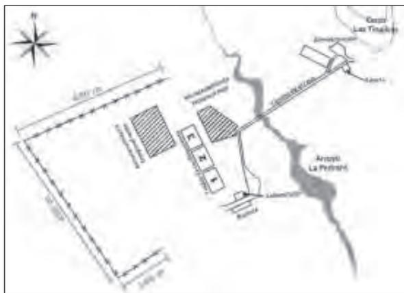
**Figura 4.** Instalaciones construidas por COTERIN en el predio La Pedrera. Entre 1990 y 1991 se dispusieron sobre el suelo, los residuos en las zonas de almacenamiento temporal y luego se transfirieron a las celdas de confinamiento (1, 2 y 3).
