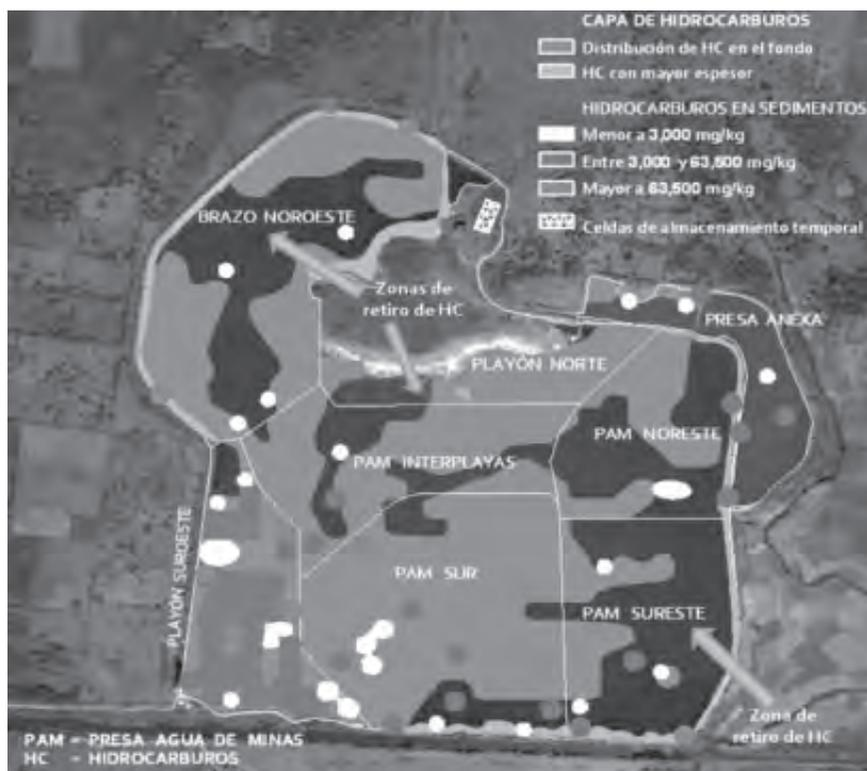
Figura 7. Distribución de hidrocarburos en las presas Agua de Minas y Anexa. Las concentraciones se refieren a HFP (Fuente: Elaboración propia).
