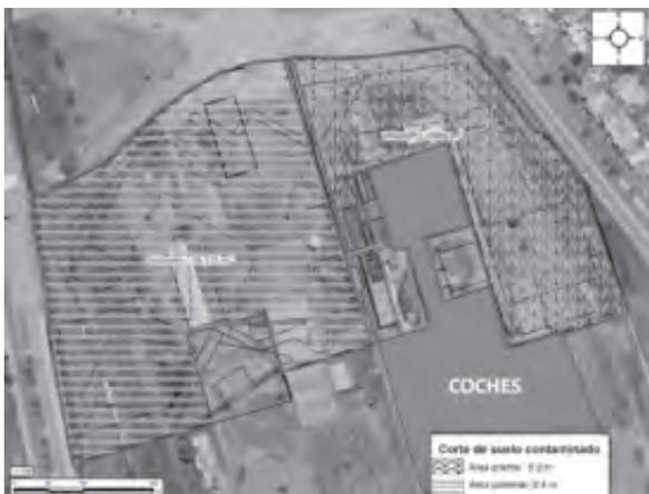
En esta celda se depositaron principalmente suelos contaminados procedentes del área donde se construyó el Nuevo Hospital de Especialidades Miguel Hidalgo (Figura 26), escorias de fundición con metales del área de fundición de hierro gris, así como hidrocarburos fracción pesada procedentes de otras áreas del predio.
