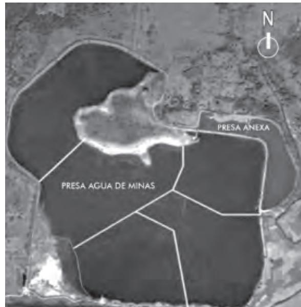
▲ **Figura 11.** Zona de remediación de sedimentos en la Presa Agua de Minas. Las líneas blancas señalan los bordos para trasportar los hidrocarburos retirados (Fuente: Elaboración propia).
