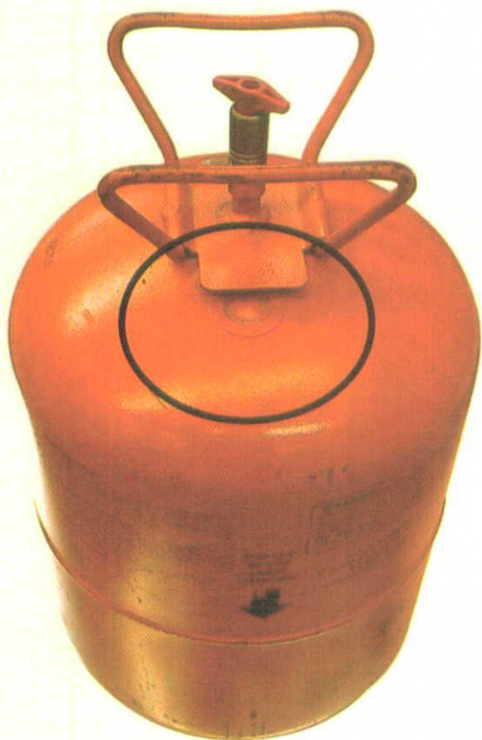
Ilustración 20. Cilindro señalando el disco de ruptura.
