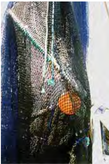
Los cabos tensores son una opción simple para prevenir la pérdida del ángulo de la parrilla, particularmente cuando las mallas que soportan la parrilla, se van deteriorando y estirando con el uso cotidiano.
