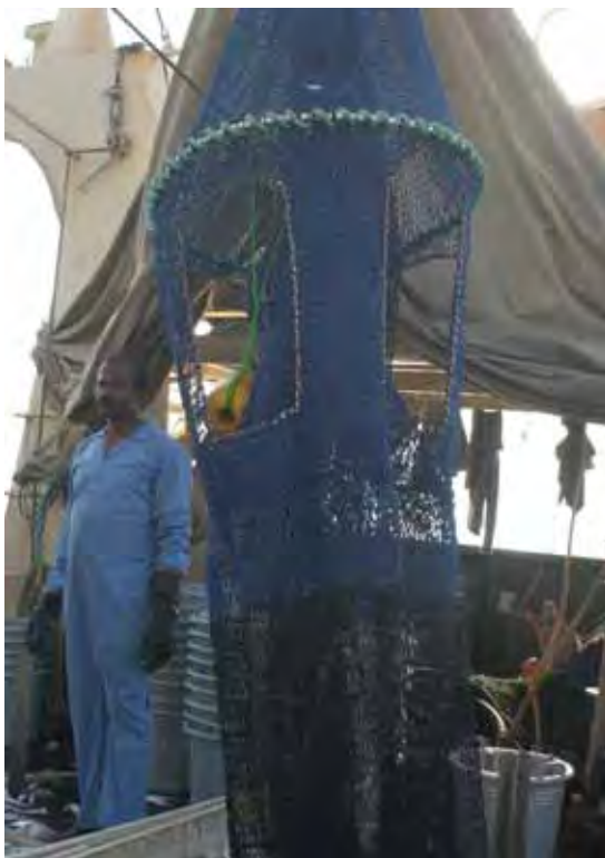
El diseño del RED permite que los peces naden hacia adelante del copo y escapen a través de las grandes aberturas de escape.
