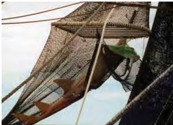
La exclusión de l pez sierra del TED es difícil independientemente de la orientación de la parrilla. Observe que este TED no tiene túnel o panel guía.
