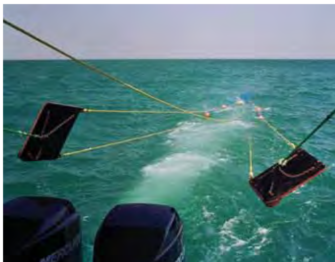
El uso de bridas largas y boyas en la relinga superior incrementarán el volumen de captura de bycatch que entra a la red.
