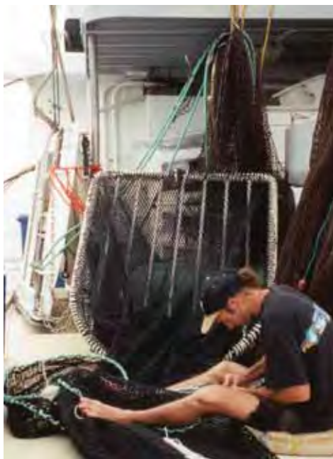
Este TED tiene una gran área de filtrado para reducir el riesgo de perde camarón. También tiene una abertura de escape grande para excluir animales grandes.
