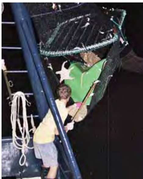
Si los cabos de izado se colocan entre el TED y el copo la remoción de esponjas y detritos de la red es una tarea simple.
