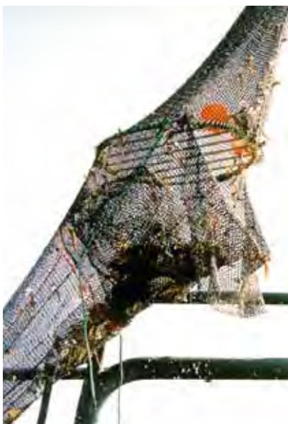
Las Parrillas ovales se ampidan bien a la forma cilíndrica del copo. Observe que la abertura de escape se extiende en parte rodeando los lados de la parrilla.
