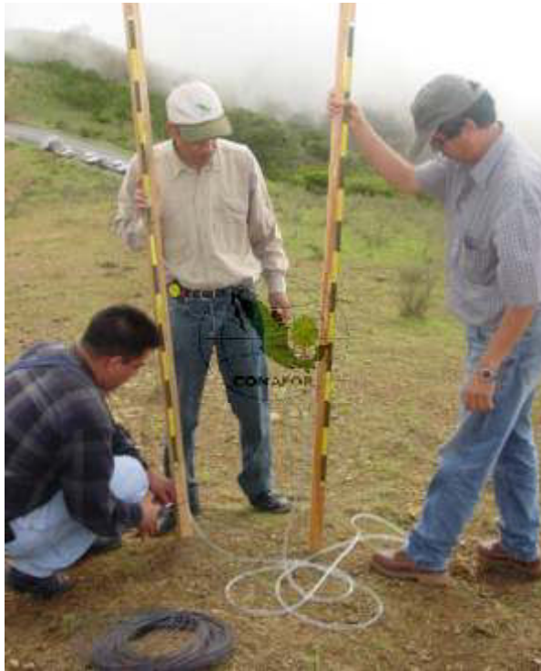
Figura 9. Construcción de nivel de manguera
