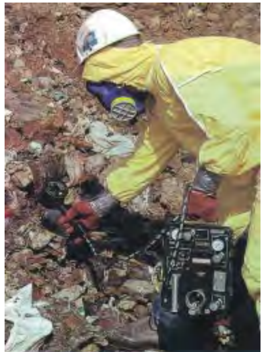
Se cuenta con técnicas para detectar la presencia de gases y compuestos peligrosos en los depósitos de desechos sólidos, en particular para determinar el grado de explosividad.
